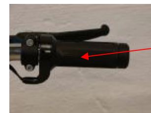
Gashåndtag til regulering af hastighed, samt "starthjælp"
