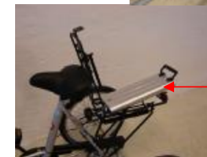
Udtagning af batteri
